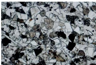
Рис. 4. Песчаник мелкозернистый аркозавый с базально-поровым равномерным карбонатным цементом. Вид – при скрещенных николях, увеличение 100X, обр. 15620-08, инт. инт. 2073-2080, место взятия 1,58 м, Малохетская свита, пласт Мх-III, скв. Тгл-4, биотит на ранней стадии аморфизации.
