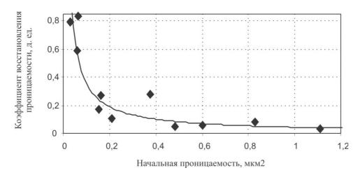
Рисунок. Восстановление проницаемости образцов
