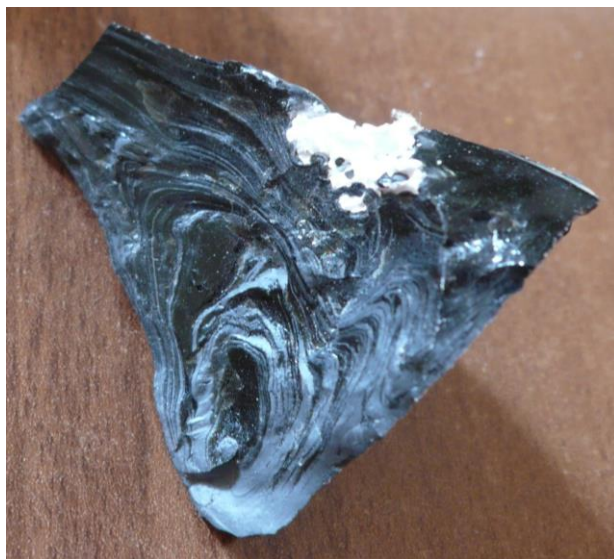
Рис. 1. Симинал с явными признаками ликвации
