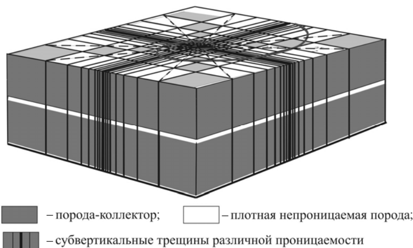
Рис.2. Феноменологическая модель рифейских продуктивных трещиноватых карбонатных резервуаров, предлагаемая для гидродинамического моделирования разработки залежей ЮТЗН
