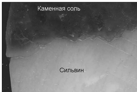
Рис. 5. Молочно-белый шпатовый сильвин, замещающий каменную соль (Даргановский поисковый участок Гремячинского месторождения, скв. 61)
