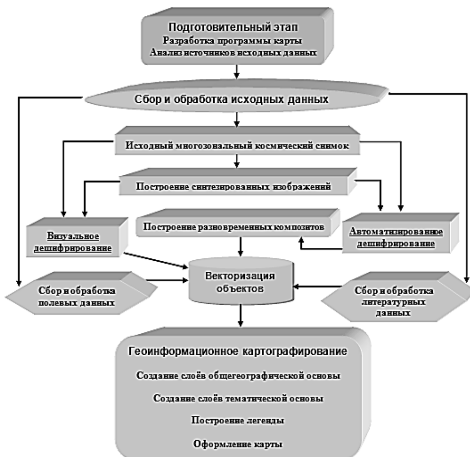
Рис. 1. Общая технологическая схема геоинформационного картографирования источников антропогенного воздействия на ландшафты
