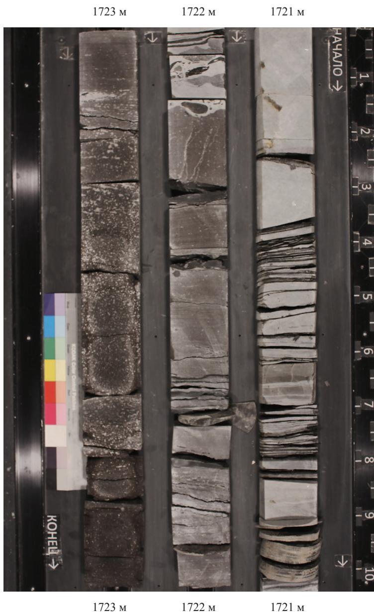
Рис. 3. Фото керн в дневном свете: глубины 1721–1724 м (для увязки с данными ГИС керн нужно опустить на 3,8 м)
