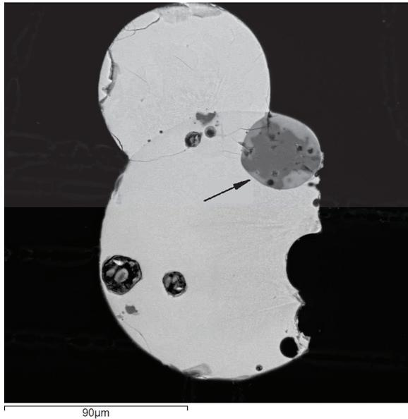
**Рис. 2.** Срез сростка двух глобул псевдорутила с многочисленными округлыми пустотками микронных и более крупных размеров (0,02...0,04 мм), приуроченными к периферии зёрен. Стрелкой указана округлая пустотка с ровными границами, заполненная зёрнами кварца, ортоклаза, титанистого биотита. Ровные вогнутые границы среза глобулы (справа) обусловлены выпавшим агрегатом зёрен минералов при изготовлении препарата. Лейкогранит, Устьянский массив
