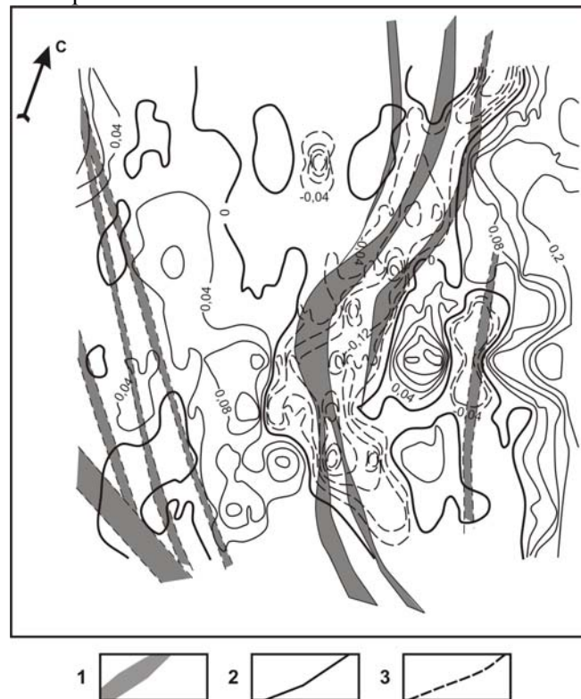
Рис. 1. Пример выделения рудного тела зондированием методом переходных процессов: 1 – рудное тело, 2 – изолинии ЭДС положительного знака, 3 – изолинии ЭДС отрицательного знака
