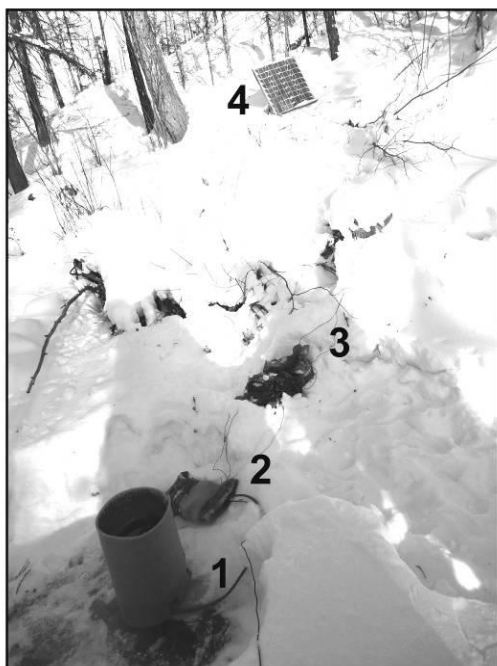
Рис. 2. Установка приборов на полевой станции BG4: 1 – сейсмометр; 2 – регистратор; 3 – аккумуляторы; 4 – солнечная батарея
