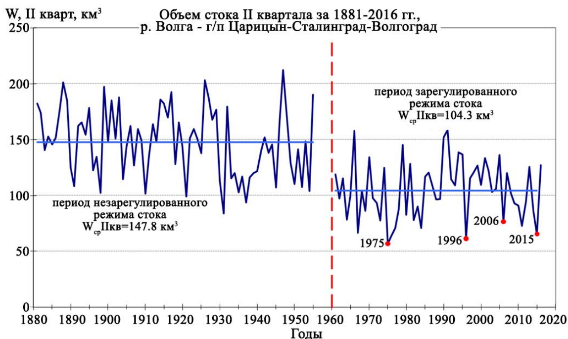
Рис. 6. Многолетняя изменчивость стока II квартала (апрель-июнь) в вершине Нижней Волги (в створе г. Волгограда) за 1881-2016 гг. Fig. 6. Perennial changes of the second quarter (April-June) flow in the highest part of the Lower Volga, in the line of Volgograd, during 1881-2016.
