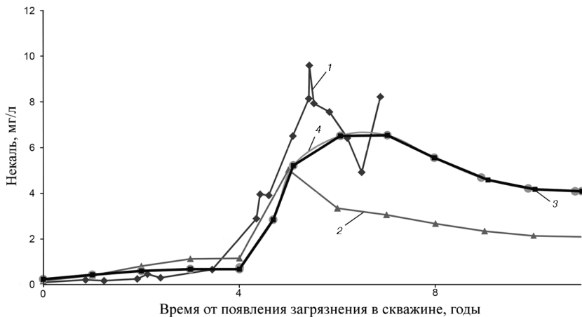
Рис. 3. Изменение концентрации некаля в водозаборной скважине для разных вариантов модели: 1 — наблюдения в скважине; 2 — двухзонная неоднородность; 3 — с учетом вертикальной неоднородности; 4 — с учетом вертикальной неоднородности и с использованием MNW
