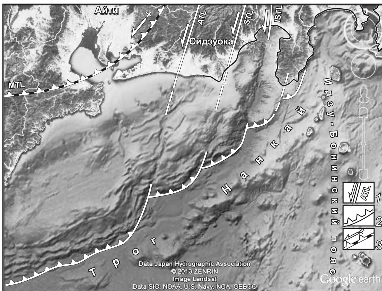
Рис. 3. Левосдвиговые дислокации нависающего края континента в пределах акватории к югу от Японии (местоположение космического снимка см. на рис. 2). 1 – левые сдвиги (тектонические линии): ATL – Акайши, STL – Сасауама, ISTL – Итоигава-Шизуока; 2 – зона срыва нависающего края континента, над которой сформированы сосдвиговые фронтальные чешуйчато-надвиговые структуры, слагающие северо-западный борт трога Нанкай; 3 – Срединная Тектоническая Линия (MTL), формировавшаяся, в основном, до отчленения Юго-Западной Японии от континента, в составе диагональной приконтинентальной системы взбросо-сдвигов (рис. 2).
