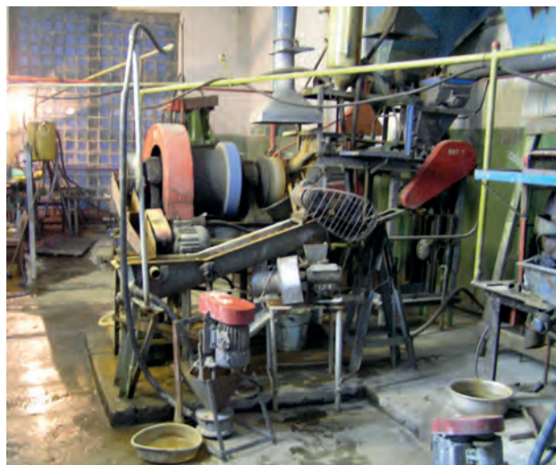
Рис. 2. Общий вид установки ОАО «Тулское НИГП», использованной для полупромышленного гравитационного обогащения 41 ЛТП. Фото автора
