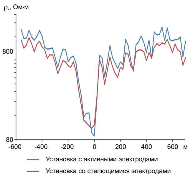
Рис. 3. ДИПОЛЬНОЕ ЭЛЕКТРИЧЕСКОЕ ПРОФИЛИРОВАНИЕ НА КИМБЕРЛИТОВОЙ ТРУБКЕ АМАКИНСКАЯ (ЯКУТИЯ, МИРНИНСКОЕ ПОЛЕ) С ЗАЗЕМЛЁННОЙ УСТАНОВКОЙ И СО СТЕЛЮЩИМИСЯ ЭЛЕКТРОДАМИ. АППАРАТУРА «ЭРА-В-ЗНАК»
