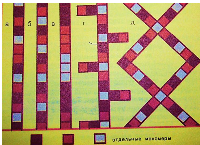
Рис. 1. Расположение мономеров в полимерных цепочках (Гладков, 1973): а – в полном беспорядке; б – в какой-либо строгой последовательности; в – группами (блоками); г – присоединением боковых цепочек; д – перекрещивающимися ветвями / Fig. 1. Arrangement of monomers in polymer chains [Gladkov, 1973]: a – in complete disarray; b – in any strict sequence; c – groups (blocks); d – joining side chains; e – crossing branches
