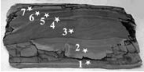
Рис. 6. Один из образцов ландшафтного мрамора, по которому в локальных зонах 1–7 выполнялись экспресс-определения элементного состава.
