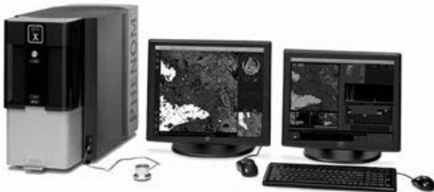
Рис. 2. Настольный сканирующий электронный микроскоп Phenom ProX со встроенной системой энергодисперсионной спектроскопии (EDS) [13].
