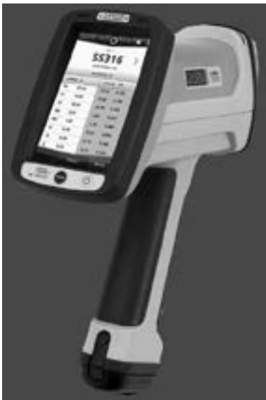
Рис. 1. Портативный рентгенофлуоресцентный спектрометр X-MET 7500, оборудованный рентгеновской трубкой с родиевым анодом, высокоразрешающим SSD-детектором и встроенным компьютером на базе ОС Linux®.
