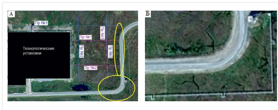
Рис. 2: А — Участок исследований с наличием активных криогенных процессов. Синими линиями представлены электротомографические профили, розовыми линиями — георадиолокационные профили. В желтых овалах показано морозобойное растрескивание; Б — Укрупненное отображение морозобойного растрескивания Fig. 2: А — Area with the presence of active cryogenic processes. The blue lines represent the electrotomographic profiles, the pink lines represent the geo-radar profiles. In the yellow oval shows the frost-shattered cracking; B — Enlarged display of frost cracking
