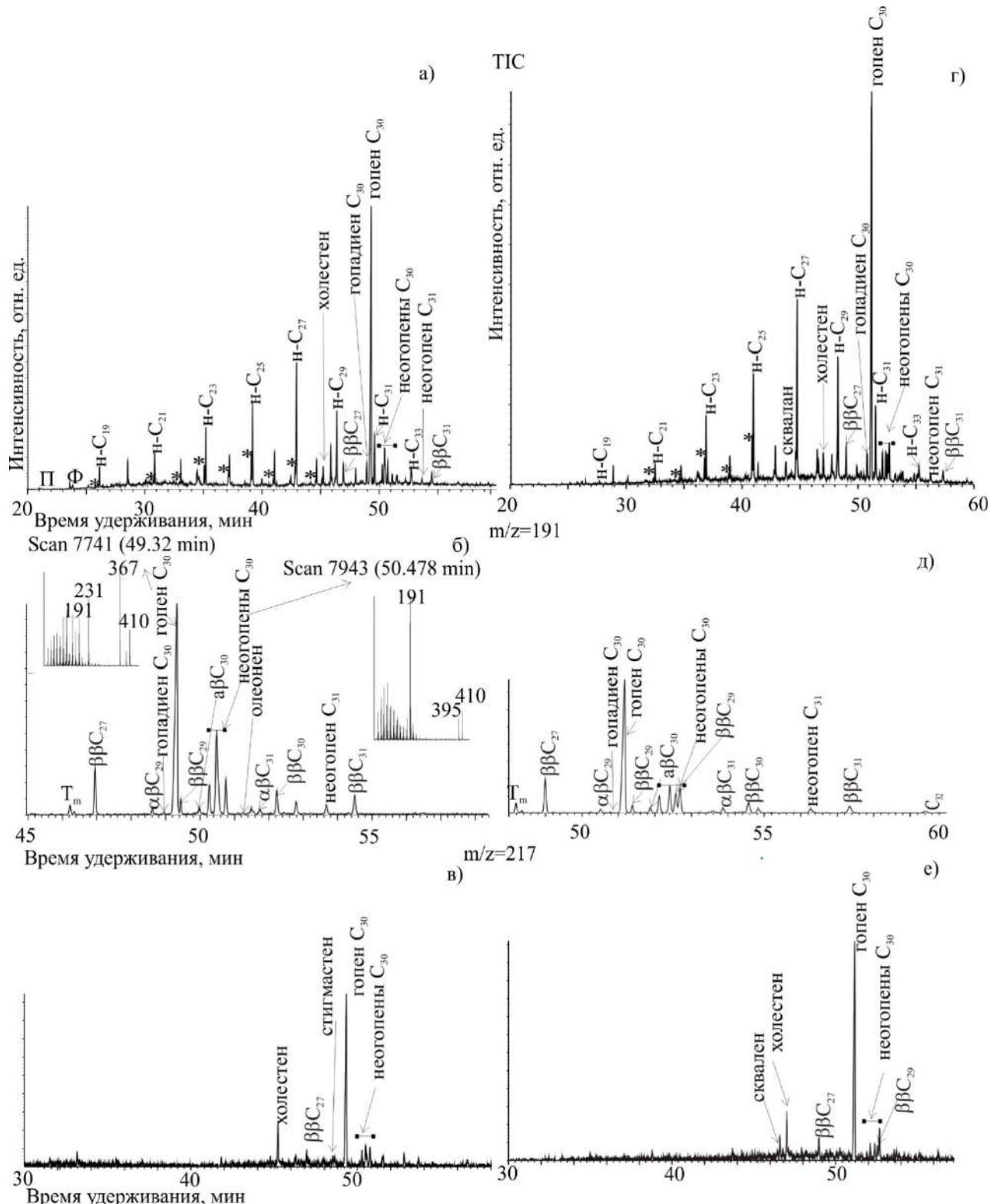
Хроматограммы по общему ионному току – TIC (а, г), фрагментограммы терпанов (б, д) и стеранов (в, е) насыщенной фракции углеводородов битумоидов донных осадков гидротермальной активности (бухта Фролиха, Северный Байкал) до (а-в) и после (г-е) термобарического культивирования (биодобавка – биомасса планктона):
