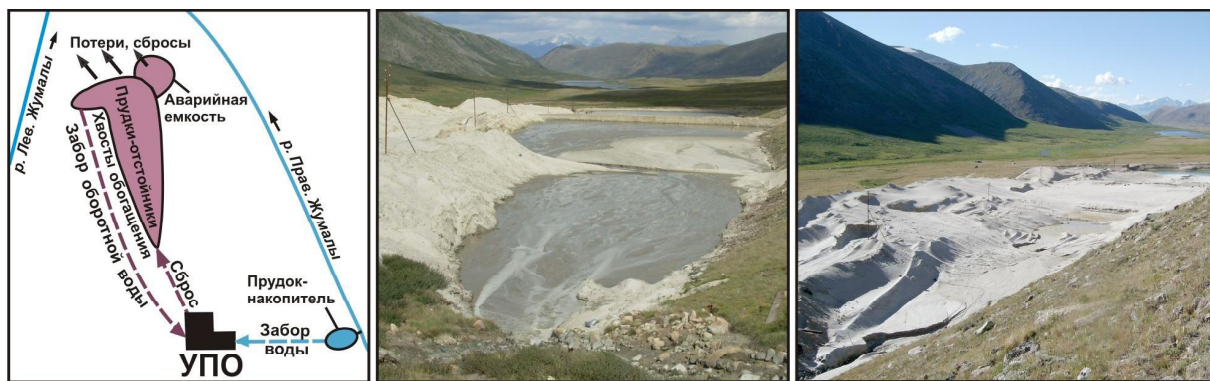
Рис. 2. Схема водоснабжения и водотведения УПО (слева), общий вид хвостохранилища при работе УПО (в центре) и в настоящее время (справа) / Fig. 2. Scheme of water supply and drainage of the equipment of pre-treatment (EPT) (left), general view of the tailings at the EPT mine (center) and currently (right)
