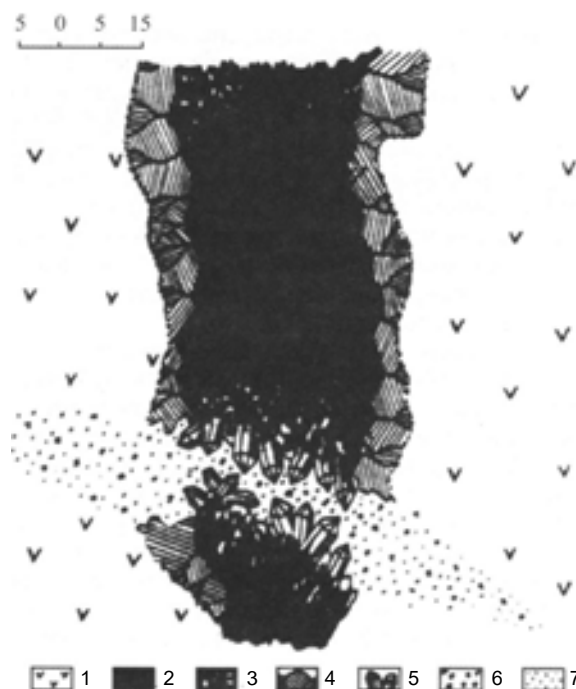
Рисунок 6. Пересечение хрусталеносным гнездом полевошпат-кварцевой жилы, локализованной в амфиболитах. Центральный блок, Светлинское месторождение. По [25]. 1 – амфиболит; 2 – жильный кварц; 3 – жильный кварц перекристаллизованный; 4 – полевошпат; 5 – кристаллы кварца; 6 – хлорит; 7 – глинистые минералы. Figure 6. Intersection of the crystal-bearing bunch of feldspar-quartz vein localized in amphibolites. Central block, Svetlinskiy deposit. According to [25]. 1 - amphibolite; 2 - vein quartz; 3 - vein quartz recrystallized; 4 - feldspar; 5 - quartz crystals; 6 - chlorite; 7 - clay minerals.
