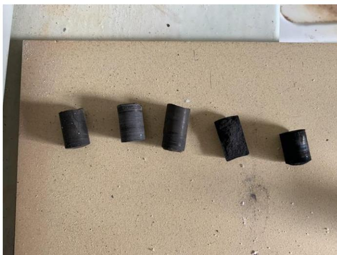
**Рисунок 1. Экспериментальные образцы после термической обработки слева направо 100-200-300-400-500 °С, соответственно.**
