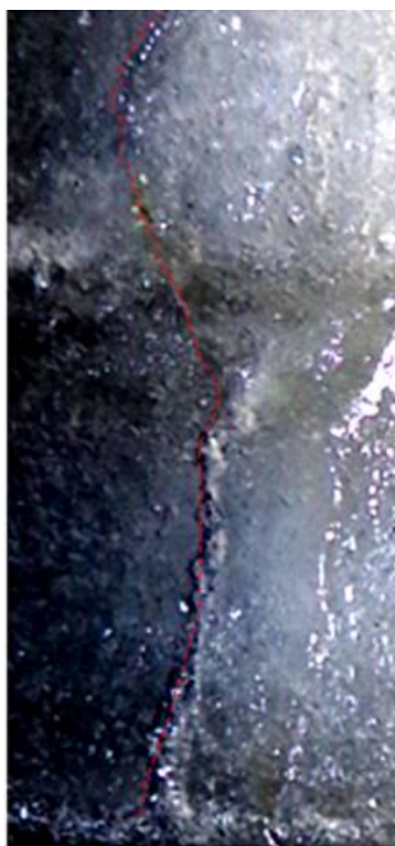
Рис. 9. Газовый канал пересекающий границы слоёв льда.
