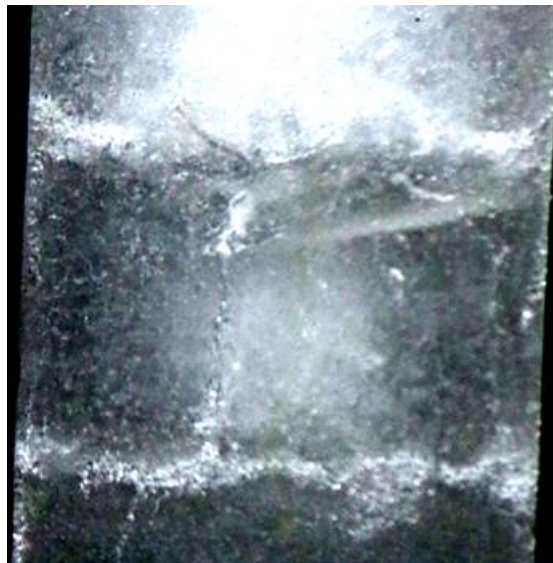
Рис. 11. Газовые каналы пересекающие слои льда. Неравномерное газовыделение на контактах слоёв. Ветвящиеся трещины в центральной части образца.
