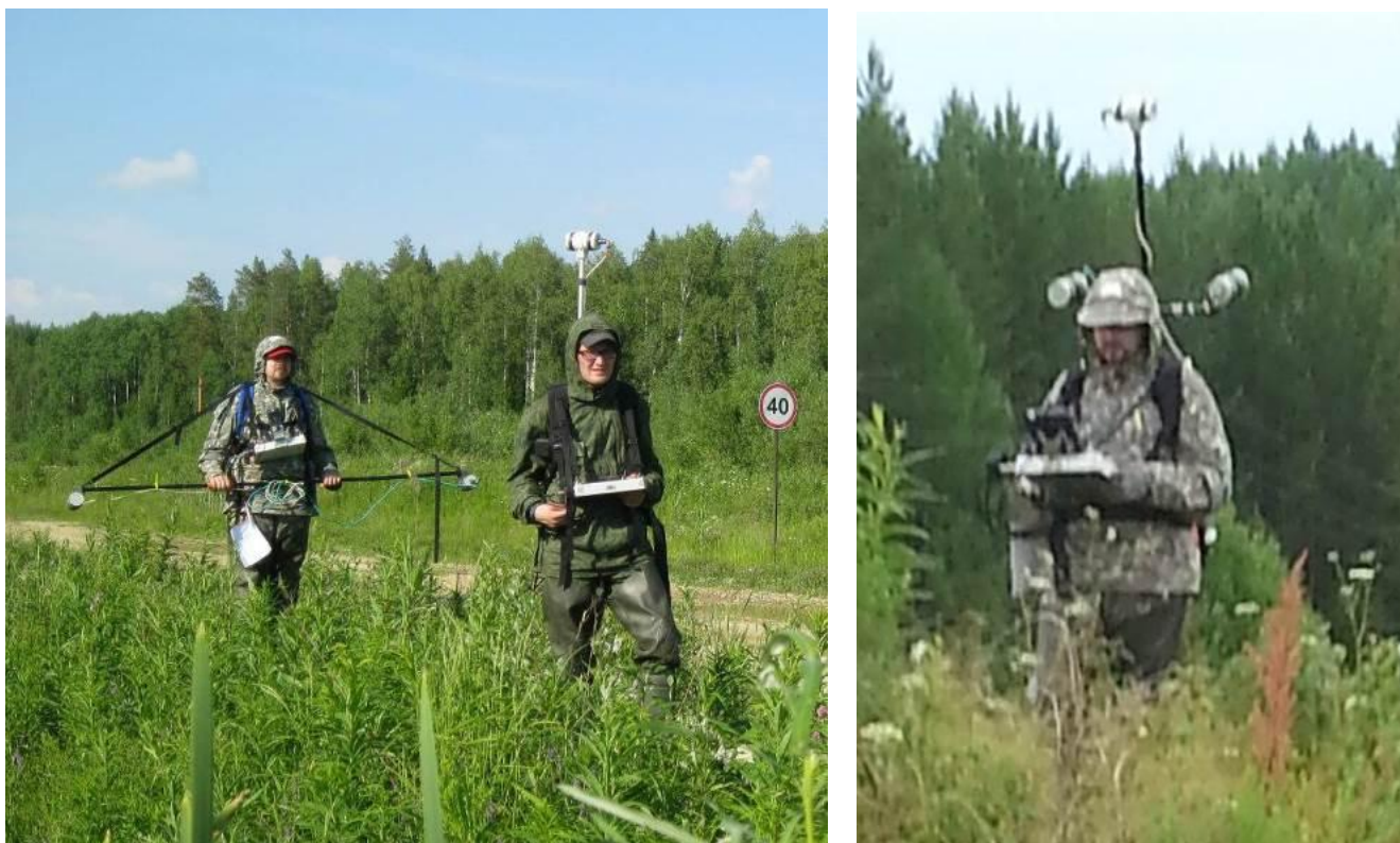
Рис. 1. Магнитная диагностика магистрального трубопровода двумя операторами и квази-многоканальным магнитометром-градиентометром. ( Магниторазведчики: ответственный исполнитель инженер-аспирант Нархов Е.Д., студенты УрФУ Федоров А.Л., Милюков Д.В. )
