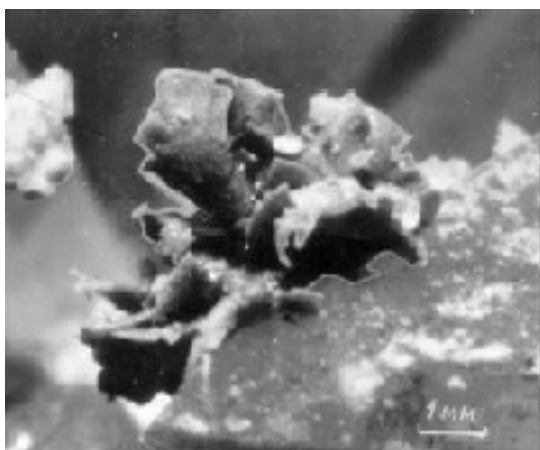
Рис. 4. Таблитчатый расщепленный блочный анкерит на кварце.
