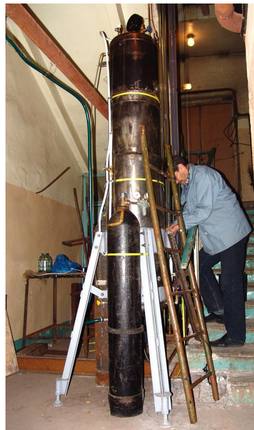
Рис. 3-13. Внешний вид бака для приготовления газонасыщенной модельной жидкости
