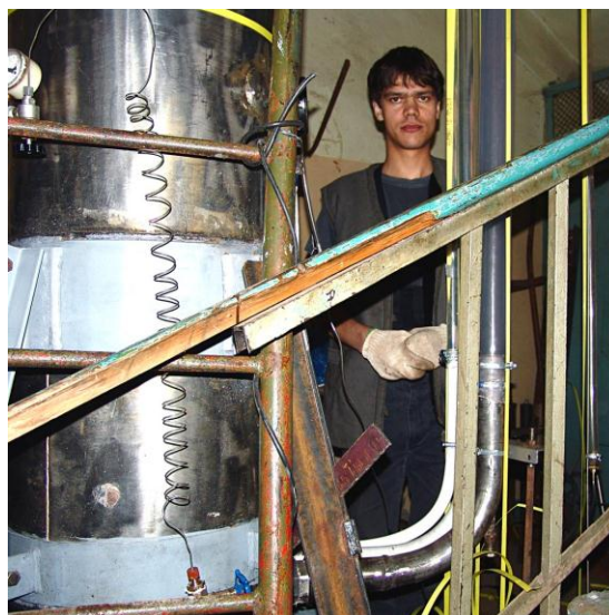
Рис. 3-14. Плавно изогнутые трубы, соединяющие герметичный бака и вертикальные пластиковые колонны.
