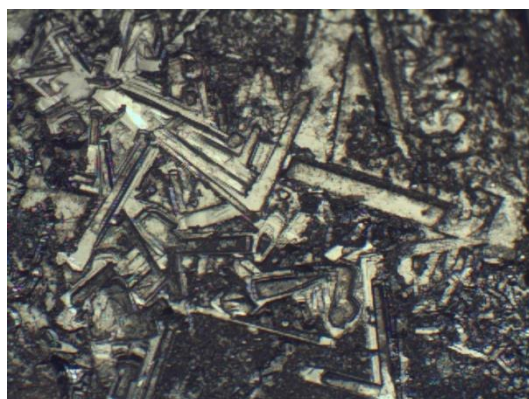
Рис. 5. Микрорельеф грани \{110\} кристалла висмутокolumбита из пегматита Мальш, В. Памир. Косое освещение. Ширина поля зрения 4 мм.
