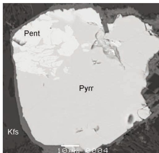
Рис. 7. Вростки пентландита (Pent) в зерне пирротина (Pyrr) в матрице калиевого полевого шпата (Kfs), г. Каскасньончорр (РЭМ-фото в отраженных электронах).
