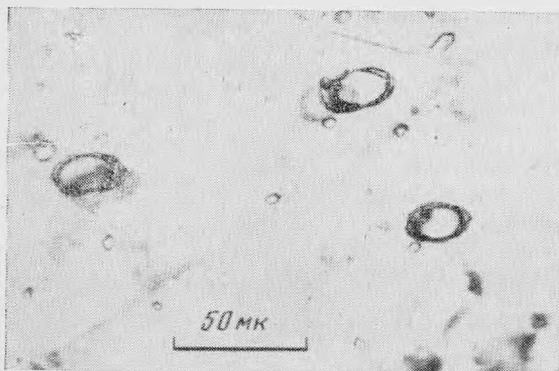
Рис. 8. Типичные фигуры травления на поверхности лепидолита. Условия травления: 40% HCl, 20° С, 15 мин.
