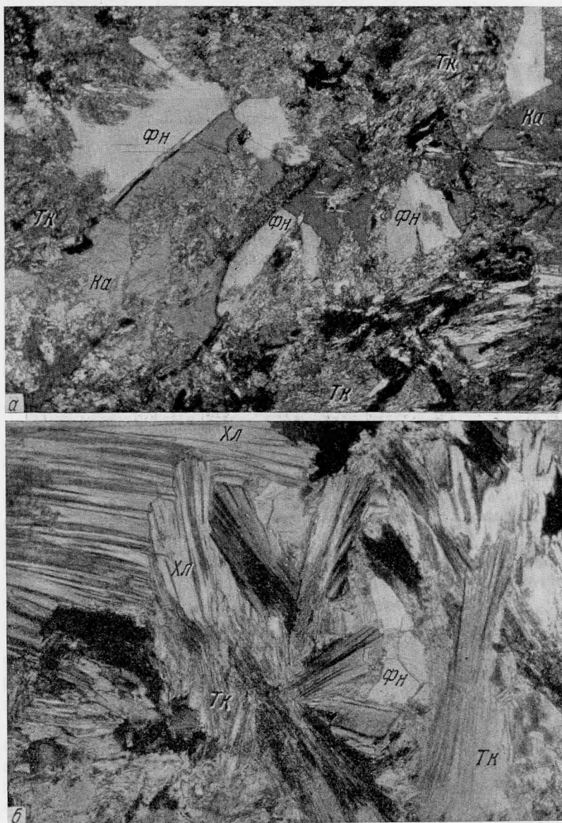
Рис. 4. Мелкие неправильной формы зерна фенакита (Фн) в тальк-хлорит-карбонатной породе (а) и в участке, состоящем из крупночешуйчатого агрегата талька (Тк) и хлорита (Хл) (б). Прозрачный шлиф. Увел. 30, николи +
