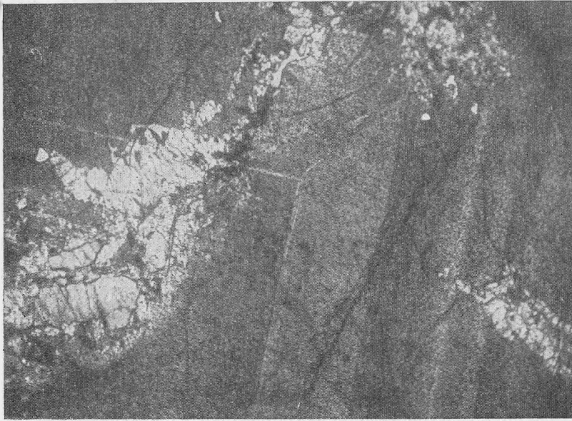
Рис. 3. Зональность роста в монокристалле гадолинита Увел. 18, николи+. Светлое — продукты изменения гадолинита
