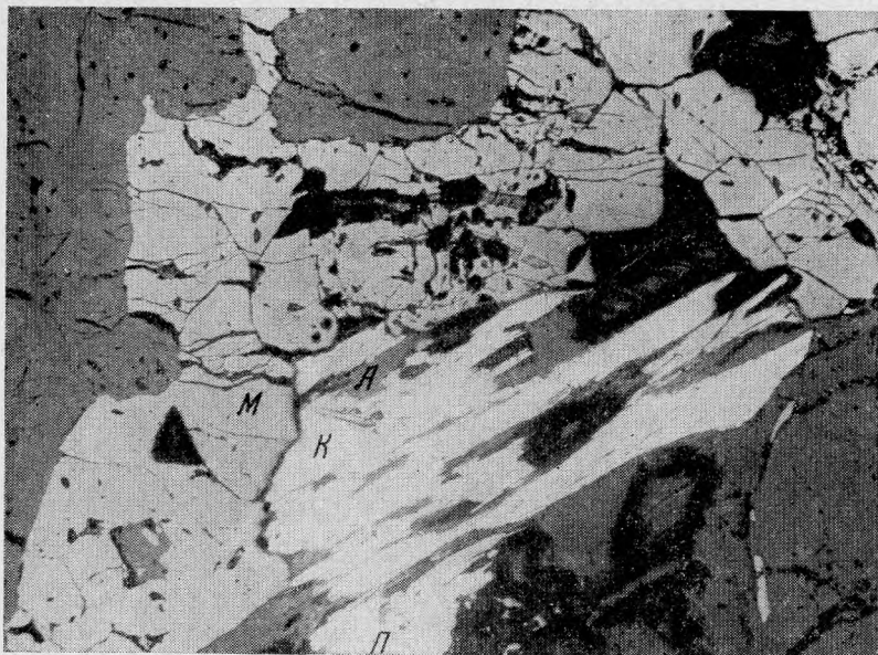
Рис. 1. Шестоватые кристаллы козалита (К) среди актинолита (А) в ассоциации с магнетитом (М) и пиритом (П), \times 70
