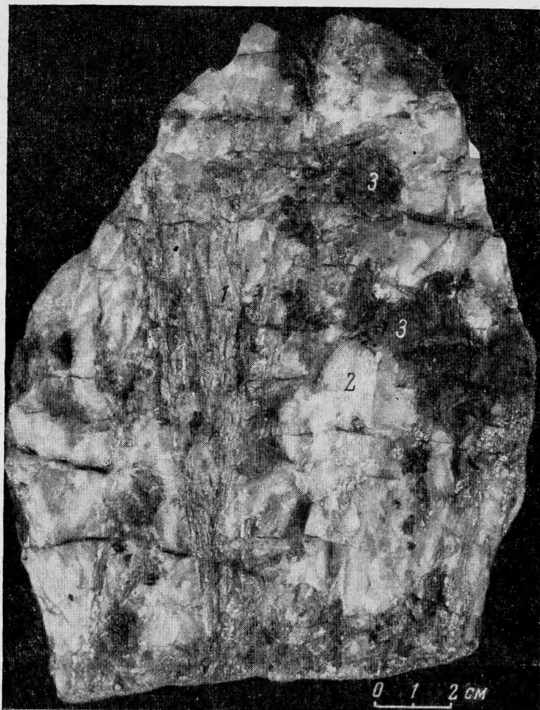
Рис. 1. Удлиненно-шестоватые агрегаты висмутина второй генерации (1) в жильном крупнокристаллическом кварце (2) с сульфидами Fe и Cu (3). Внизу — тонкая слюдяная оторочка
