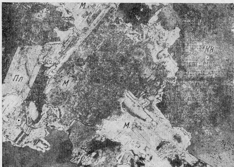
Рис. 3. Мелкие кристаллы стрюверита, приуроченные к зерну мусковита, замещающему биотит. Прозрачный шлиф. Николи скрещены, увел. 30
