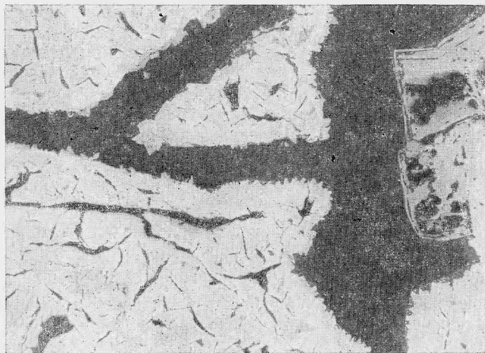
Рис. 5. Образование крустификационной каймы позднего халькопирита II (белое), лишенной трещин усадки, на трещиноватом агрегате халькопирита, заместившем борнит (серое, реликты); черное — кальцит, темно-серое — халькозин. Увел. 120
