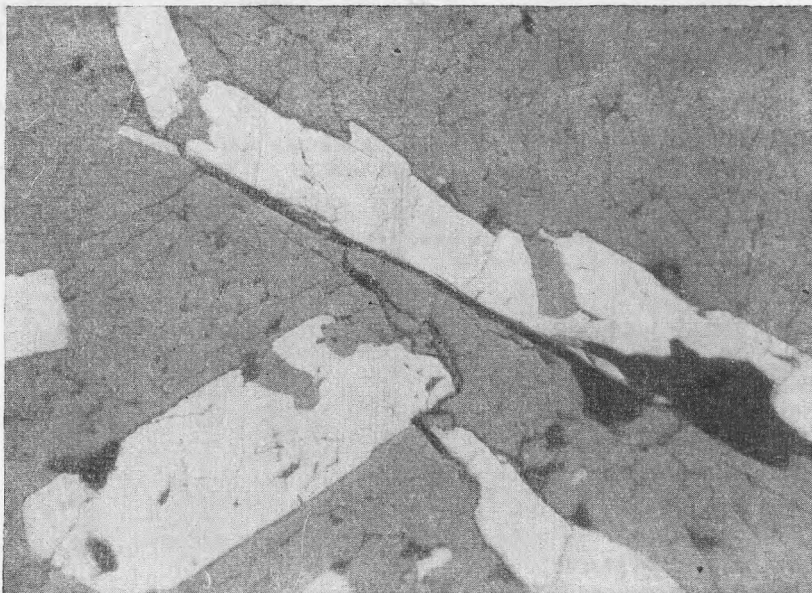
Рис. 8. Полированный шлиф. Пегматит Ж, обр. 56—57. При одном никеле, увел. 40. Тонкопластинчатый колумбит, очень трудно травящийся, бедный Ta_2O_5 . Травление HF в течение 1 часа не оставило никаких следов
