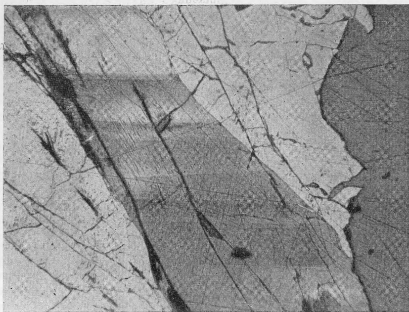
Рис. 2. Полированный шлиф. Пегматит В, обр. 25. При одном николе, увел. 40. Видно зональное строение с ядром, более богатым Ta_2O_5 . Протравлен HF в течение 15 мин. Белое — участки, не затронутые травлением
