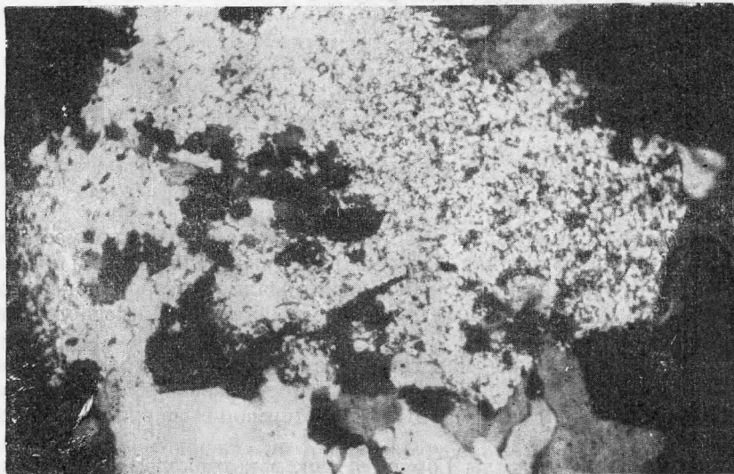
Рис. 1. Мелкочешуйчатые агрегаты гидрослюда в кварцевой жиле. Николи +, \times 160
