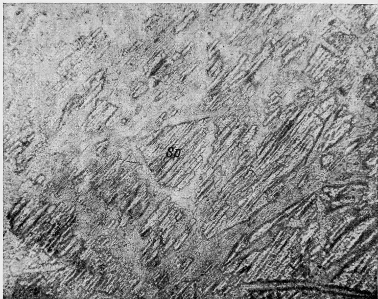
Рис. 26. Выветрелый сподумен. Реликты сподумена (Sp) в галлаузите. \times 135 , без анализатора.
