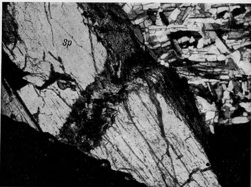
Рис. 22. Мелкокристаллический агрегат альбита и эвкриптита, образовавшийся по сподумену на контакте его с альбитом. \times 46 , ник. +
