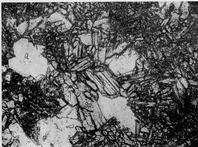
Рис. 15. Кварц-сподуменный агрегат — псевдоморфоза по петалиту (без анализатора). Q — кварц; Sp — сподумен. \times 78 .
