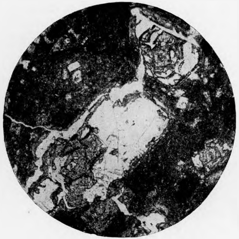
Рис. 3. Опал (серый), образованный по плагиоклазу. \times 46 , николи +.
