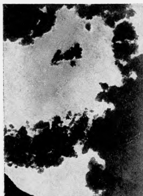
Рис. 8. Кумакская глина — каолинит (тонкая фракция). \times 8000 .
