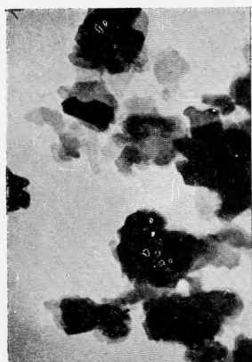
Рис. 15. Каолинит просяновский, прокаленный при 200^{\circ} . \times 17\ 400 .
