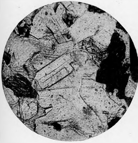
Рис. 2. Кристобалит около плагиоклаза в центре шлифа. \times 90 , без анализатора.
