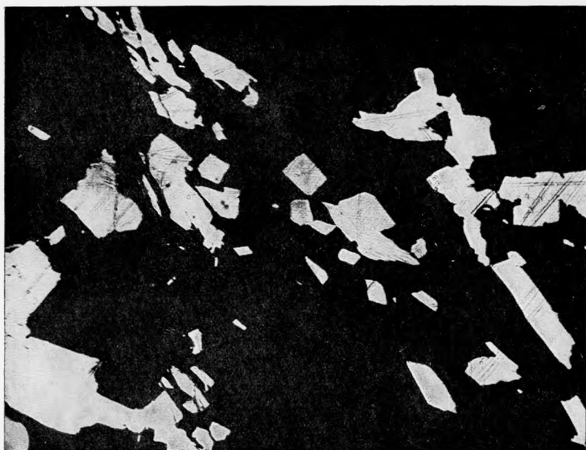
Рис. 7. Поперечное сечение кристаллов висмутового джемсонита (серое). × 450.
