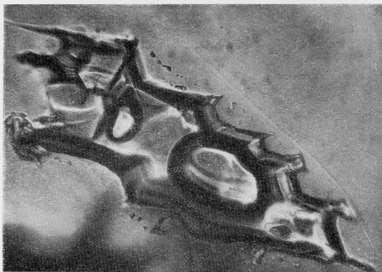
Рис. 16. Каемка вокруг включения в топазе в виде слабо намечающейся линии. Между каемкой и включением цепочка мелких включений. \times 400 .
