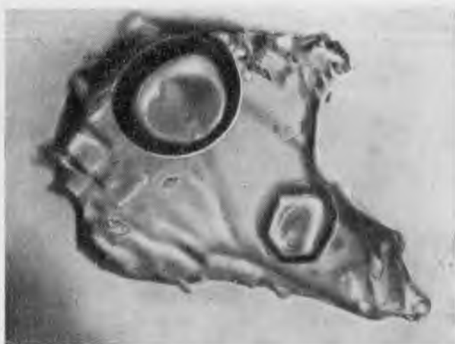
Рис. 21. Включение в кварце. Внутри включения — кристаллы топаза. \times 400 .
