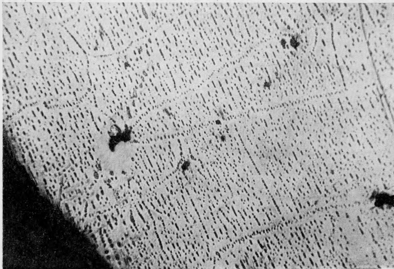
Рис. 2. Структура распада ильменита на ильменит + магнетит (дер. Полдневая). \times 150 .
