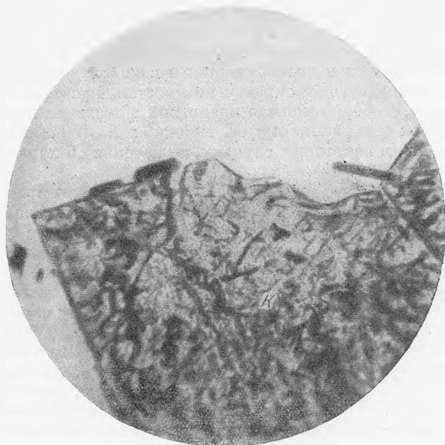
Рис. 14. Нарастание кристаллов колумбита (черное) различными гранями на различные же грани кристалла касситерита (k). Ув. 90; без анализатора.
