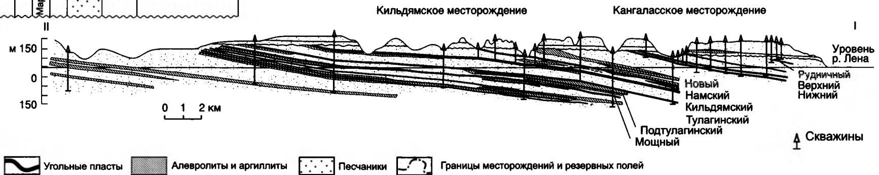
Рис. 17.2. Обзорная карта и стратиграфическое положение угольных пластов Кангаласского месторождения
