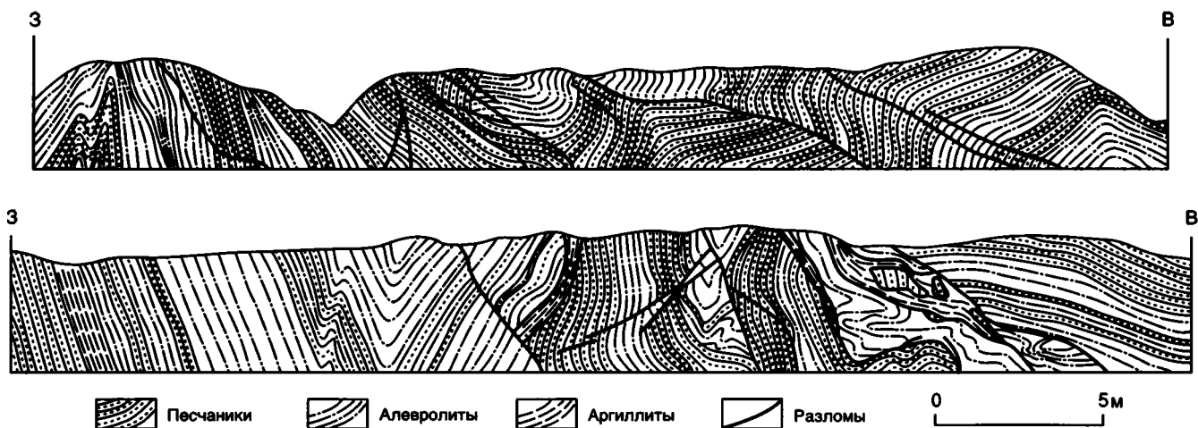
Рис. 6.31. Характер деформаций верхнетриасовых отложений Адыча-Эльгинского антиклинория (нижнее течение р. Нельгесе) (Архипов, Парфенов, 1980)
