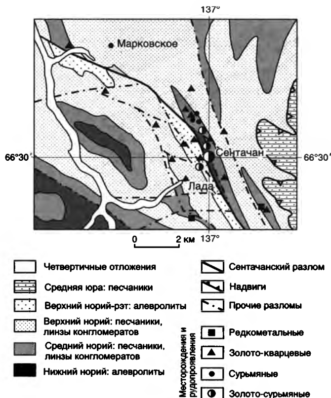
Рис. 12.14. Схема геологического строения Au-Sb Сентачанского рудного узла (Владимиров, 1977)
