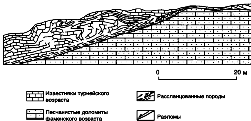
Рис. 5.28. Листрический сброс в фамениских и турнейских отложениях Хараулахского хребта (правый берег р. Лены) (Парфенов, 1987а) Местоположение разреза см. на рис. 5.23
