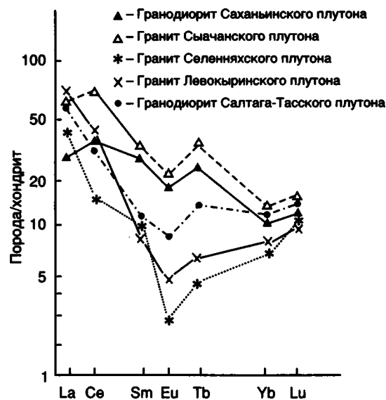
Рис. 8.2. Нормированное по хондриту распределение редкоземельных элементов в породах гранодиорит-гранитной формации Главного батолитового пояса
