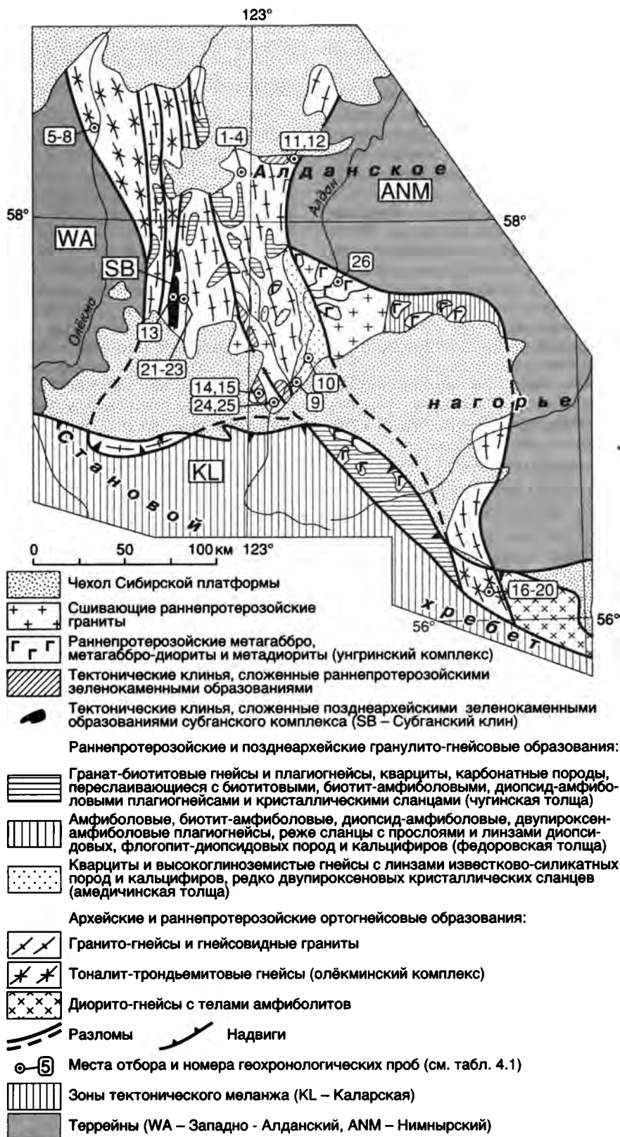
Рис. 4.6. Схематическая геологическая карта Амгинской зоны тектонического меланжа
