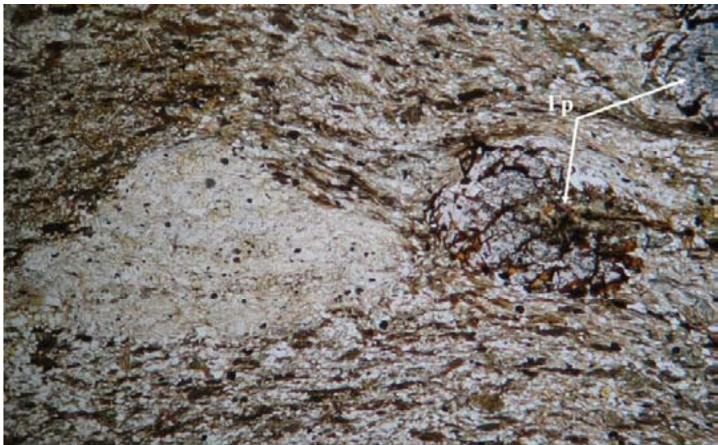
Рис. 3. Метагравелит кординской свиты. Обломки представлены спутанно-лепидобластическим агрегатом мусковита, образовавшегося при метаморфизме обломков кварц-иллитового состава химической коры выветривания (белое пятно). Цемент метаалевролит-гранат-биотит-кварцевого состава. Фото прозрачного шлифа без анализатора. Месторождение «Благодатное», поверхность
