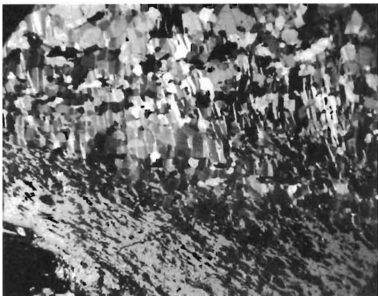
Рис. 24. Сильно деформированная сплошная сульфидная руда с двойниками давления (вверху) и признаками течения (внизу). Месторождение Каула Полированный шлиф
