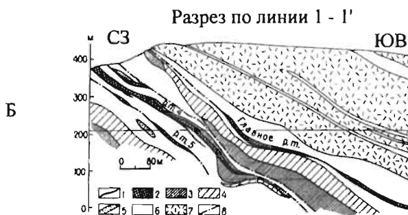
Рис. 42. Схематический геолого-структурный план горизонта 210 м месторождения Семилетка (А) и геологический разрез (Б) (по материалам комбината "Печенганикель" и КНЦ РАН). Р.т. – рудное тело
