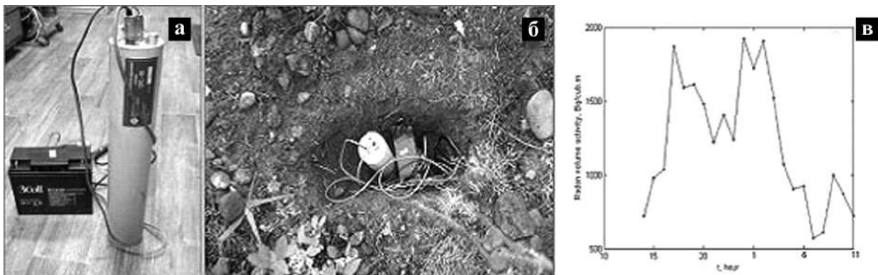
Рис. 4.69. Сейсмическая радоновая станция «СРС-05» в нерабочем (а) и рабочем (б) состояниях, временная изменчивость объемной активности радона в тектонической зоне месторождения Оутокумпу (Финляндия) (в)
