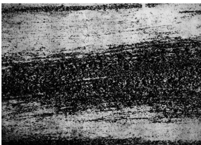
Рис. 4.6. Рибекит-магнетитовый кварцит, микрослоистая текстура, Костомукшское месторождение. Проходящий свет, ув. 6х, шл. 228–21 (а), 228–34 (б)
