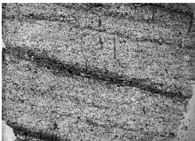
Рис. 4.4. Магнетитовый сланец. Проходящий свет, ув. 6х, шл. 15 б –32
