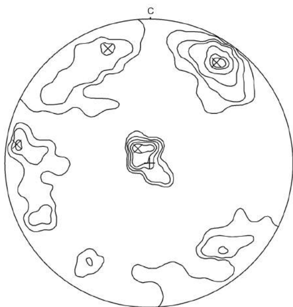
Рис. 4.64. Диаграмма трещиноватости гнейсо-гранитов на проявлении Войницкое-2. 200 замеров [Рылеев, Пудовкин, 1980ф]
