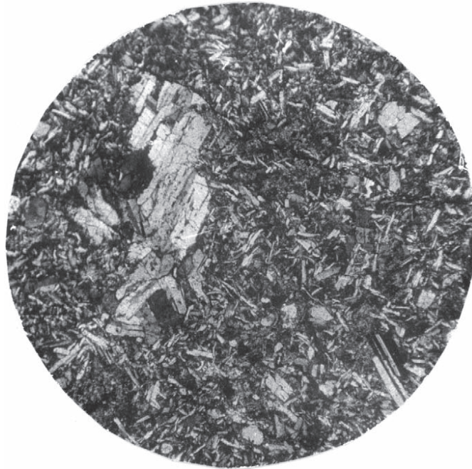
Фото 15. Плагиоклазовый порфирит андезито-дацитового состава, субвулканическая (дайковая) фация. Шлиф 6662. Увеличение 15 x . Николи скрещены
