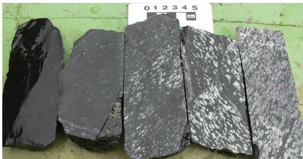
Фото 34. Срезы керна скв. 29, с разных глубин. Разная степень калищпатизации гипербазита, вплоть до сиенита (справа)
