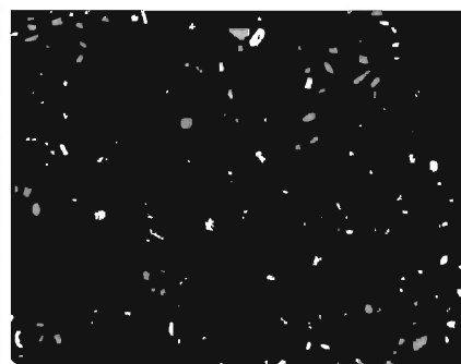
Фрагмент тяжелого концентрата пробы 52 под сканирующим электронным микроскопом. Фракция 71-37μm, BSE изображение.
