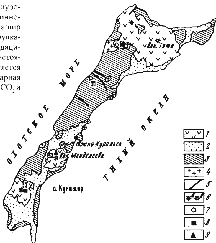
Рис. 1. Геологическая схема острова Кунашир с размещением на нем вулканов и месторождений и проявлений самородной серы. Составил В.Е. Бевз [9] 1 - вулканогенные четвертичные образования; 2 - осадочные четвертичные отложения; 3 - неогеновые отложения; 4 - миоценовые интрузии; 5 - разломы; 6 - вулканы: потухшие (а), действующие (б); 7-9 - самородная сера в: 7 - импрегнационно-метасоматических проявлениях, 8 - кратерно-озерных месторождениях, 9 - сублимационных месторождениях. Месторождения и проявления самородной серы: 50 - Шульгинское, 51 - Ильинские, 52 - вулкана Менделеева, 53 - вулкана Головнина
